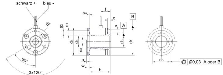
Anschlusskabel 400 mm lang UL-Style 1007/1569 CSA-TR64 Größe: AWG 26
